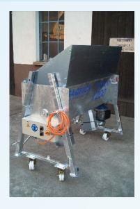
Insacchettatrice ad alta velocità Saquick Titan 1200 ad azionamento elettrico 380V progettata per preparare nel più breve tempo possibile sacchi di sabbia nella gestione di piccole e medie emergenze alluvionali.
