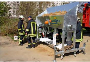
Insacchettatrice ad alta velocità Saquick Titan 2400 ad azionamento elettrico 380V progettata per preparare nel più breve tempo possibile sacchi di sabbia nella gestione di piccole e medie emergenze alluvionali.
